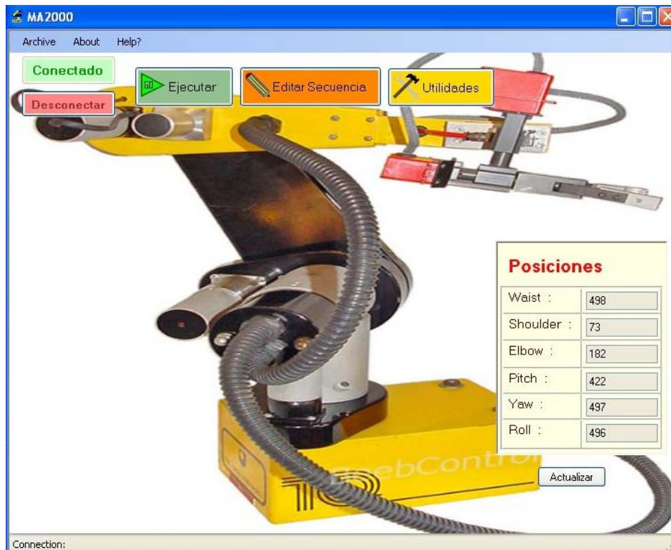
Figura 6. Obtención de las posiciones de las articulaciones del robot
