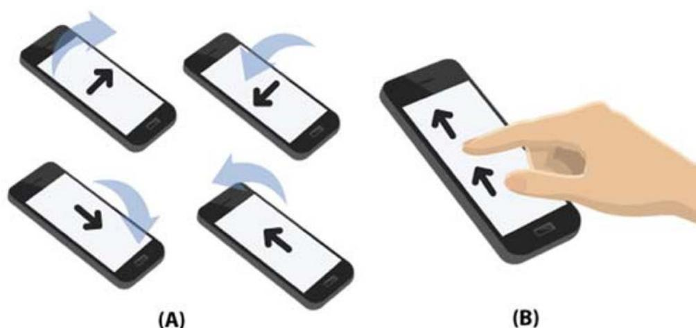
**Figura 26 (A) Inclinaciones del teléfono permitidas por el dispositivo móvil (B) Interacción mediante el control táctil**
