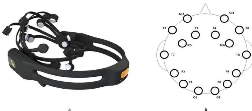
**Figura 29 . a) Emotiv EPOC+ de b) Distribución de los sensores del EPOC+ en la cabeza de los sujetos.**
