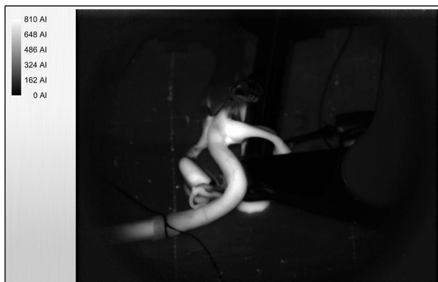
Figura 74.- Mapa de intensidad de señal del segundo pulso sobre la arteria vertebral izquierda con su diámetro externo reducido a la mitad del valor inicial por el micrómetro.
