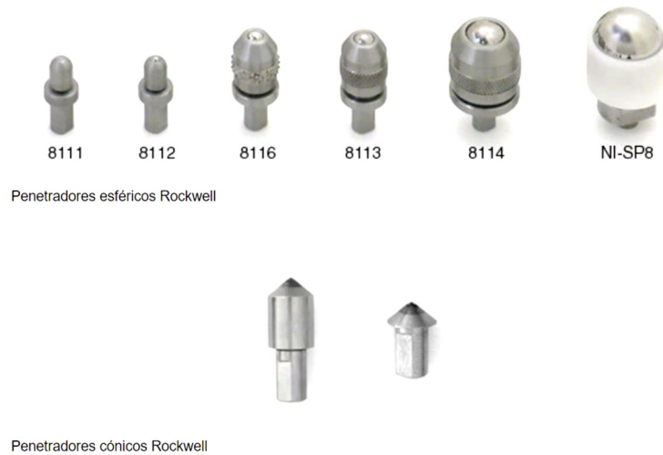
Figura 2. Penetradores de bola y diamante para ensayo Rockwell [ ].
