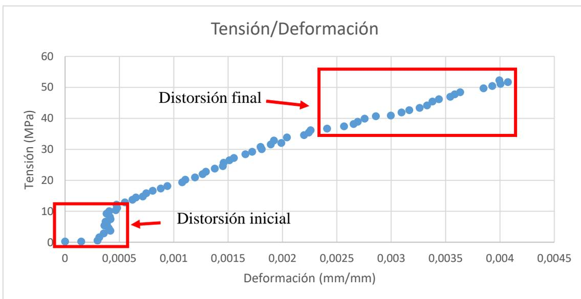
Figura 6.13: Distorsión inicial en la zona elástica y final en la zona elasto-plástica y plástica. Probeta A8
