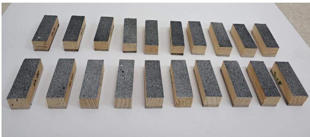
*Figura 5.5: Probetas con moteado en el plano de estudio*
