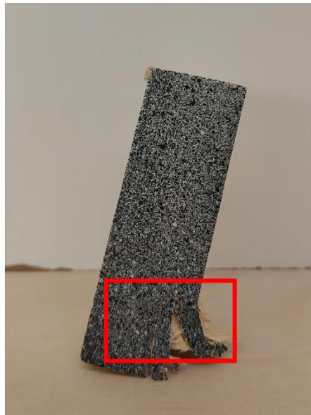
*Figura 5.10: Probeta con rotura por aplastamiento*
