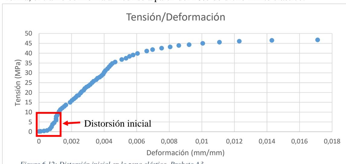
Figura 6.12: Distorsión inicial en la zona elástica. Probeta A3
