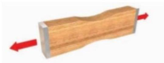
Figura 3.4: Tracción paralela a las fibras
