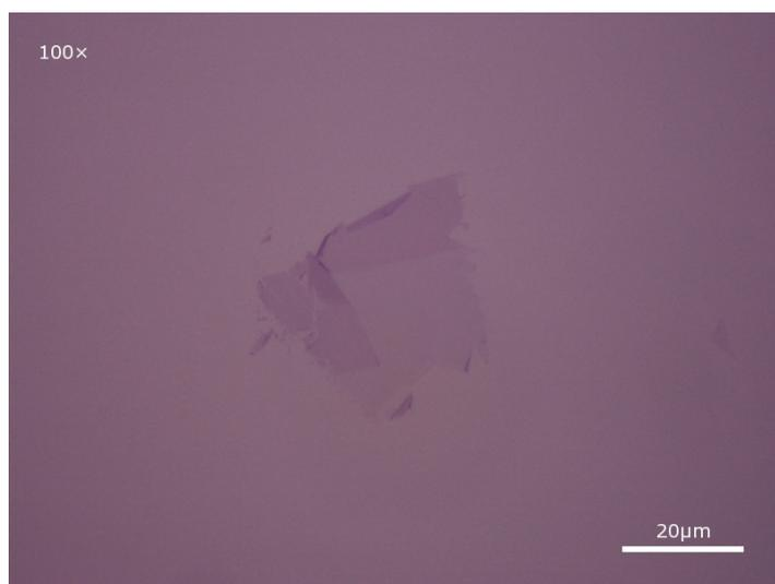
Figura 1.2: Imágen de grafeno monocapa (zona con menor contraste) obtenida en el laboratorio mediante un microscopio electrónico.
