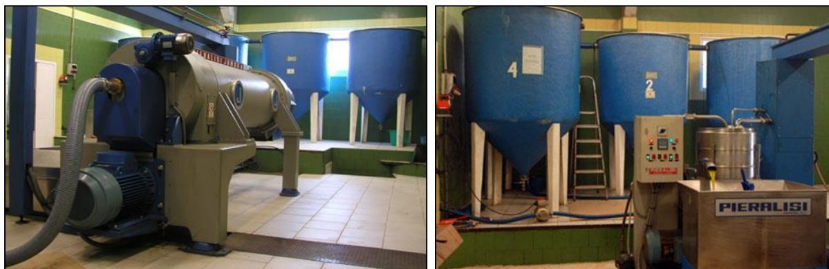
Figura 6. Centrifugadora y decantadores de la Cooperativa “Alta Alcarria”. En esta almazara (situada en la localidad de Valdeolivas) se elabora aceite de oliva virgen extra que pertenece a la D.O.P. “Aceite de la Alcarria” (Cooperativa Alta Alcarria, s.f.).
