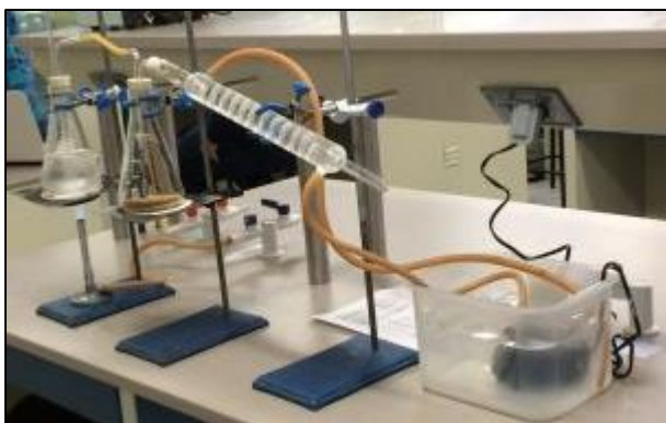
Figura 19. Montaje y materiales de la Práctica 2 FYQ.1B. (Tu tarea escolar, s.f.). De izquierda a derecha observamos: matraz generador de vapor de agua, matraz de destilación (con extracto seco de espliego), condensador y matraz colector (no aparece en la Figura 19), en el cual se observarían dos fases: aceite esencial (fase orgánica) e hidrolato (fase acuosa), los cuales pueden ser separados por decantación.
