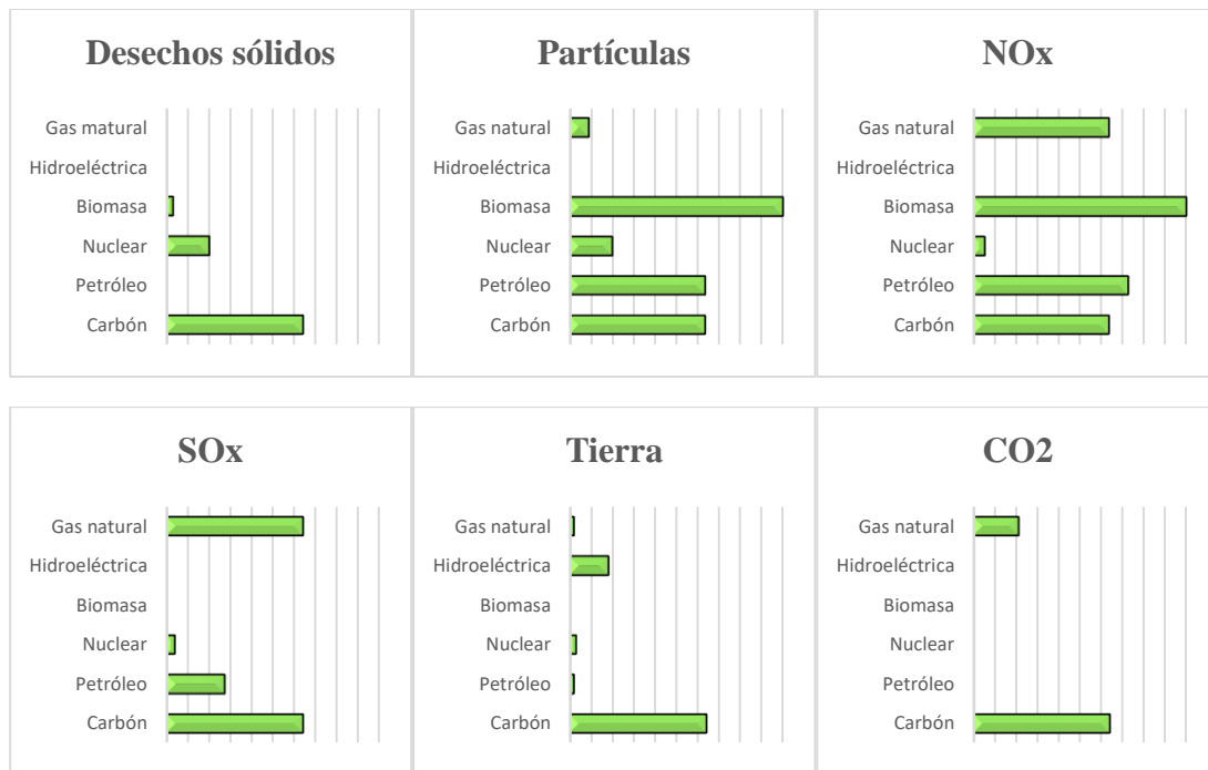
Figura 16. Emisiones de diferentes fuentes de energía. Los datos se muestran en una escala de 1 a 10, correspondiendo 10 a mayores concentraciones de los productos indicados. Los datos se presentan en proporciones relativas. Modificado de Haddad y Dones, 1991.
