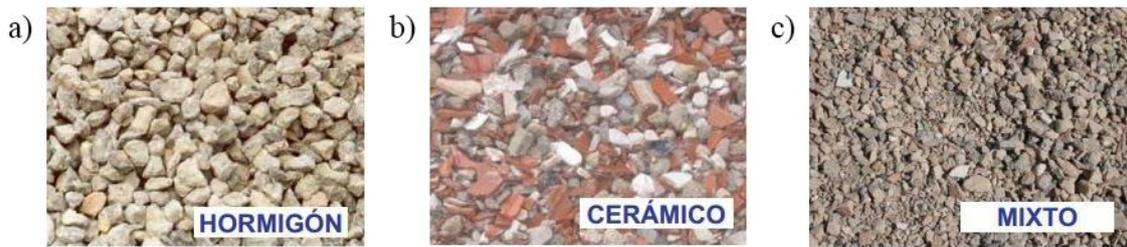
Figura 2: Áridos procedentes de RCD. a) Áridos reciclados de hormigón; b) Áridos reciclados cerámicos; c) Áridos reciclados mixtos. Fuente: (MásQueIngeniería, 2018).
