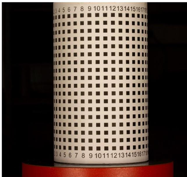
Figura 16: Objeto de calibración cilíndrico. Fuente: Elaboración propia.
