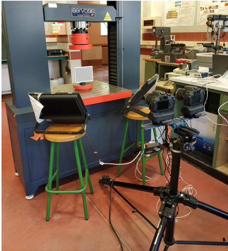
Figura 15: Configuración del prototipo empleado para 3D-DIC. Fuente: Elaboración propia.
