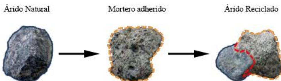
Figura 3: Árido reciclado constituido por árido natural y mortero adherido. Fuente: Adaptada de (Bai, Zhu, Liu, & Liu, 2020).
