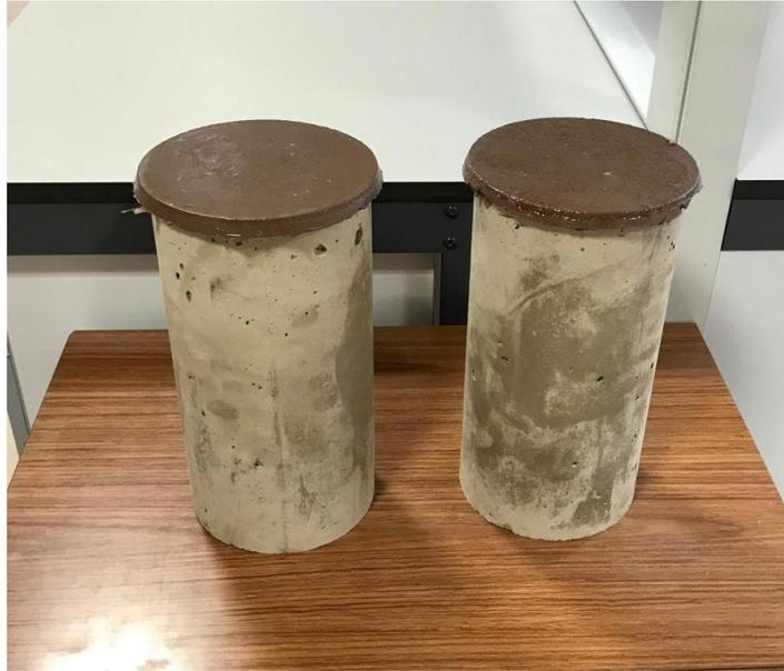
Figura 12: Probetas fabricadas de hormigón reciclado con refrentado de azufre. Fuente: Elaboración propia.
