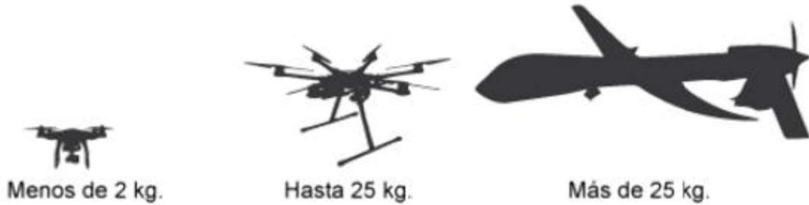
Figura 5. Tipología de drones atendiendo a su capacidad de carga en el despegue<sup>4</sup>.
