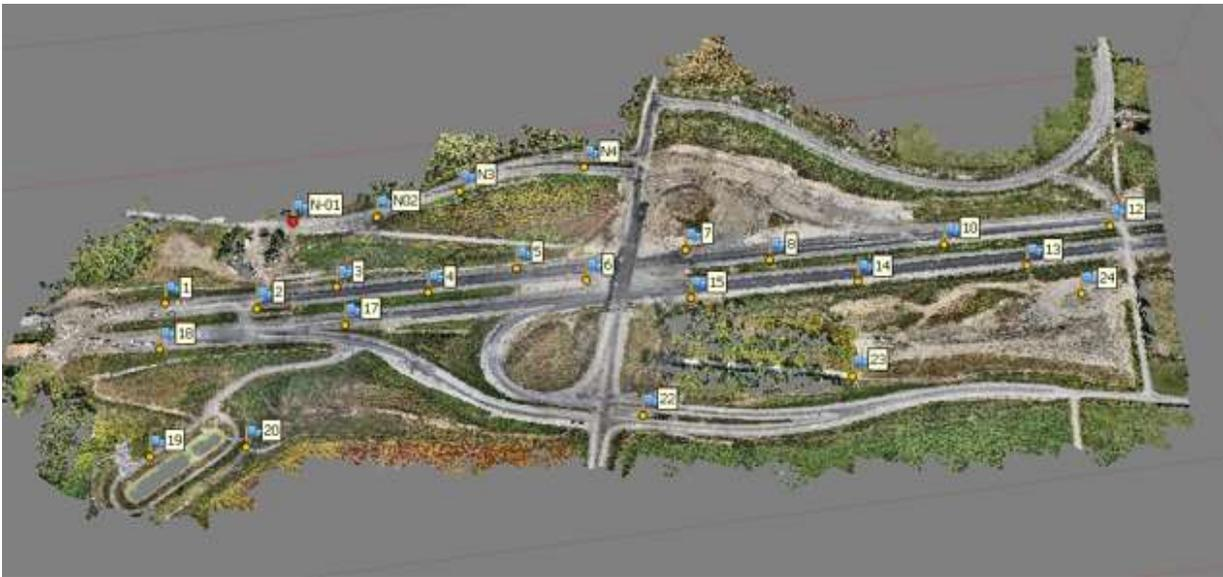
Figura 25. Localización puntos de control. Fuente: imagen propia.
