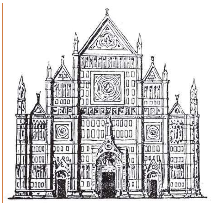
Figura 52. Diseño S. Petronio de Angelo Corovati da Milano (Concurso de 1886). Análisis insuficiente de los pilares de esquina. Extraído de Savorra (2015: 84).
