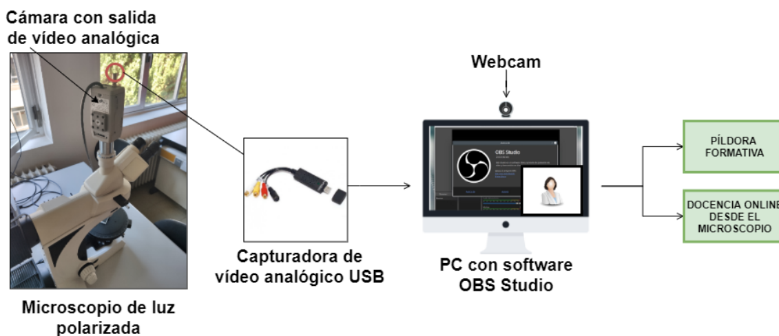
Ilustración 1 Obtención de las fuentes de vídeo de la cámara del microscopio, webcam y pantalla de PC
