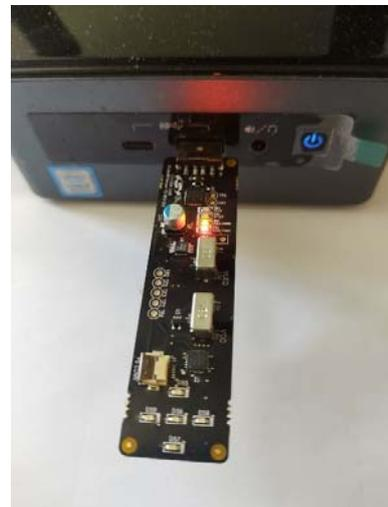
**Figura 2.** Placa PCB de Silicon Labs conectada a un PC.
