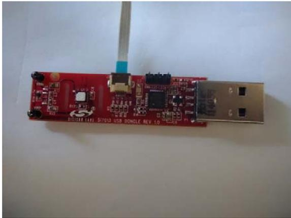
**Figura 4.** Módulo sensor USB Si7013. Panel de control de la EB.
