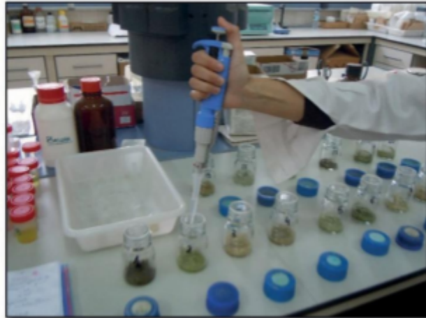
Figura 13: Preparación de las muestras para su posterior digestión.
