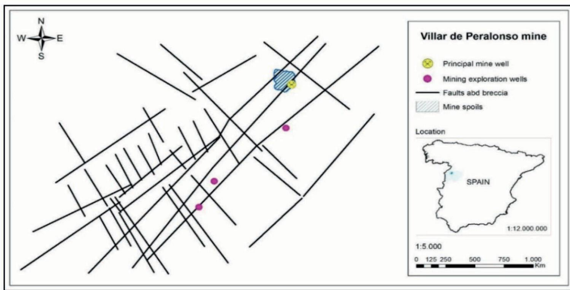
Figura 66: Fracturas y fallas del yacimiento de Villar de Peralonso.
