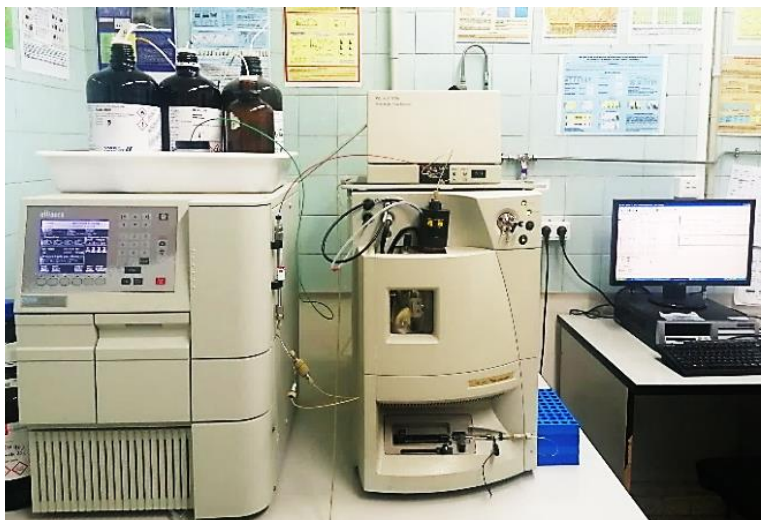
Figura 19. Cromatógrafo líquido de alta eficacia acoplado a detector de fotodiodos y masas (HPLC–DAD–MS) para la cuantificación de herbicidas y metabolitos
