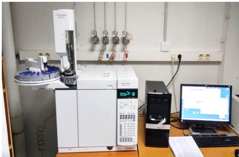
Figura 29. Cromatógrafo de gases acoplado a un detector de ionización de llama (GC-FID) para la cuantificación de los fosfolípidos (PLFAs)
