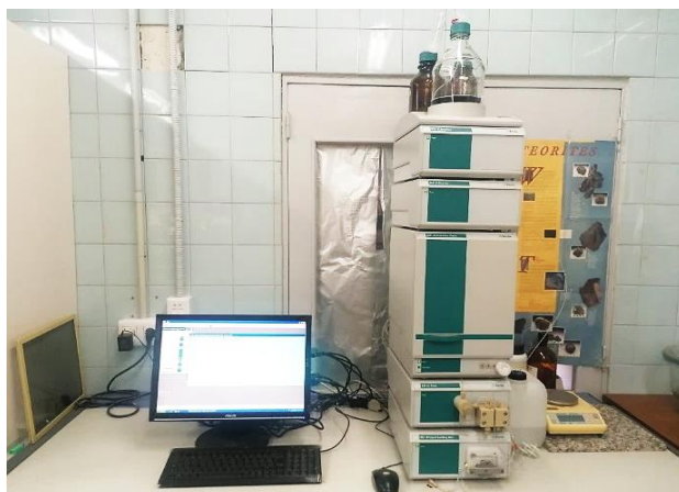
Figura 24. Cromatógrafo iónico (IC) con detector de conductividad para la cuantificación del ion \text{Br}^-
