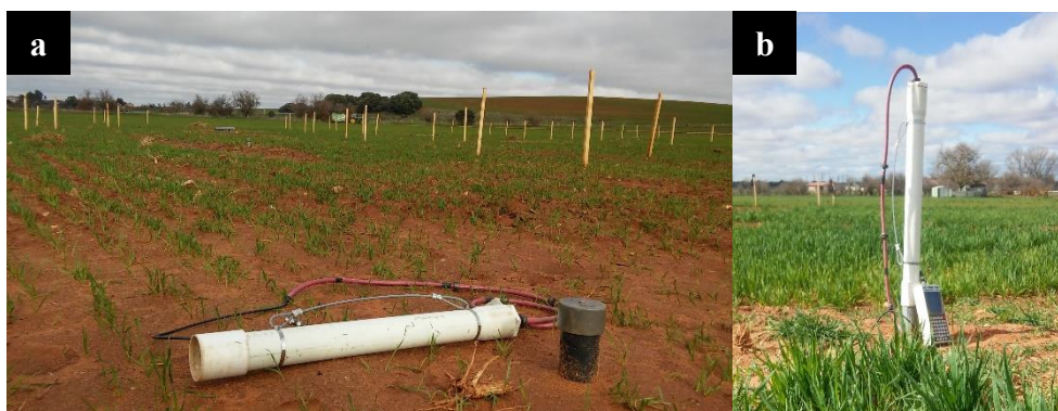
Figura 15. a) Parcela equipada con tubo de PVC para medir la humedad del suelo en el perfil usando una sonda eléctrica portátil, y b) sonda portátil Troxler Sentry 200-AP
