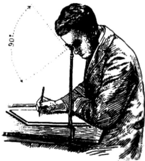
Fig. 11a. Imagen que representa a una persona dibujando con una cámara lúcida. Fig. 11b. Detalle de la parte superior de una cámara lúcida.
