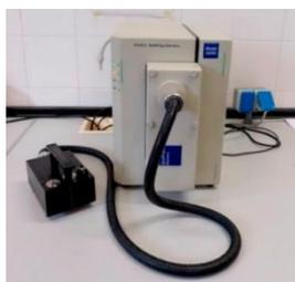
*Imagen 3-9: Sonda de fibra óptica acoplada al equipo NIRS*
