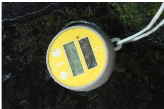
Figura 25. Medição da temperatura da água.
