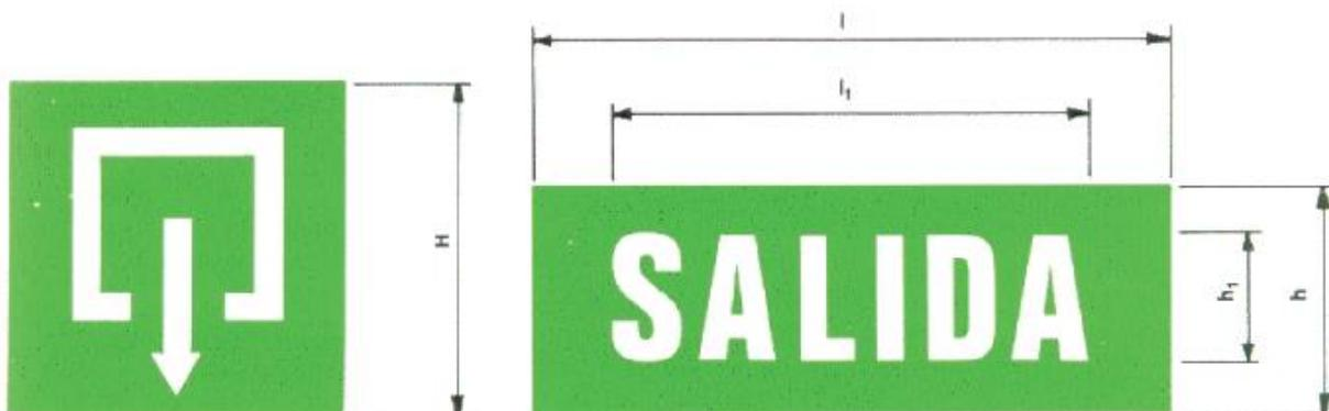
Ilustración 1 Pictograma A2 y señal literal de Salida
