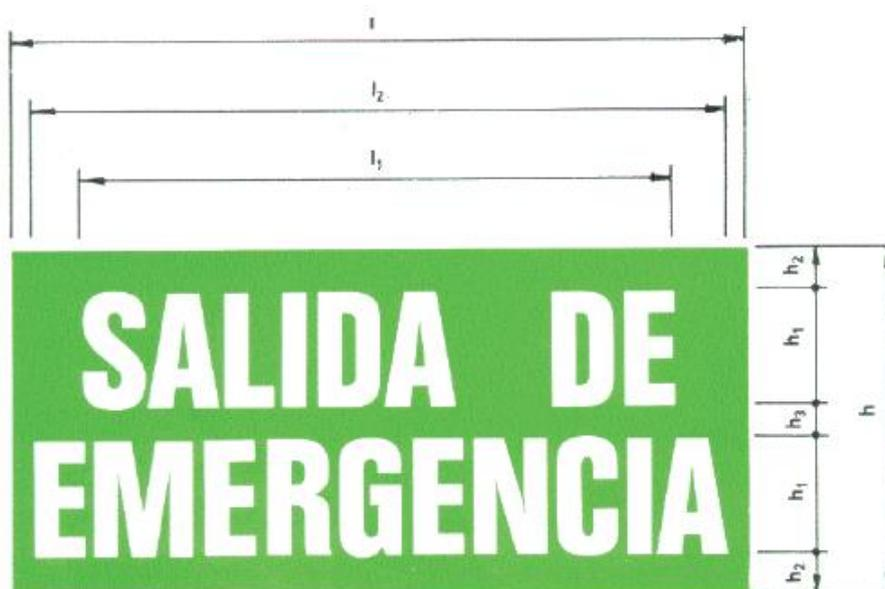
Ilustración 2 Señal de salida de emergencia
