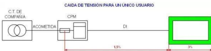
Ilustración 1 Esquema eléctrico para un único usuario
