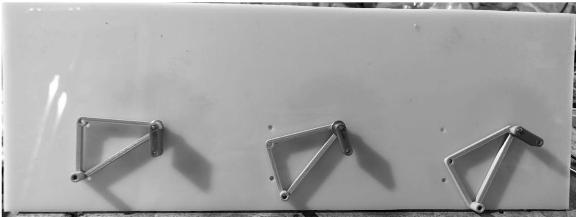
Figura 150 - Montaje de los soportes y de las manivelas de un lateral del hexápodo.
