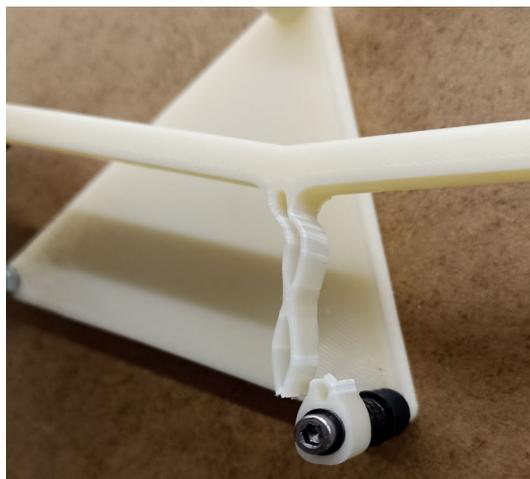
*Figura 103 - Rotura producida en el balancín cuerpo de aspas del modelo gran huella.*
