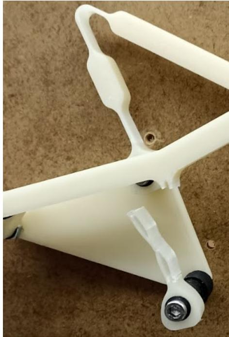
*Figura 128 - Ruptura del balancín cuerpo de aspas del modelo balancín.*
