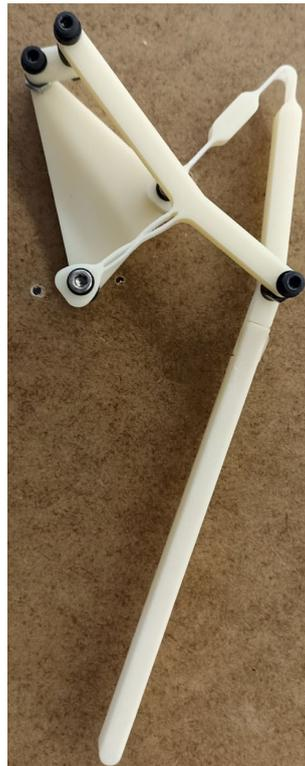
Figura 127 - Modelo balancín del mecanismo de Klann impreso en ABS.
