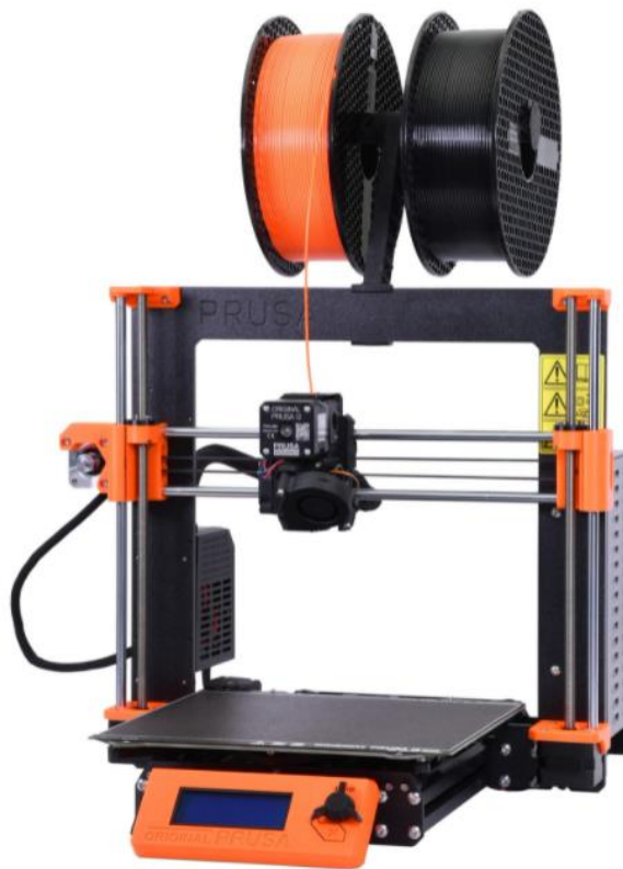
Figura 5. 1. Impresora PRUSA i3 MK3S empleada para la producción de las piezas del prototipo
