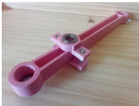
Figura 5.63. Mecanismo de sujeción en el acoplador
