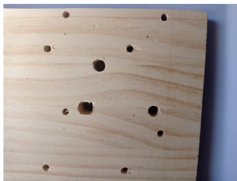
Figura 5. 60. Orificios pasantes para la sujeción de las piezas con el soporte.
