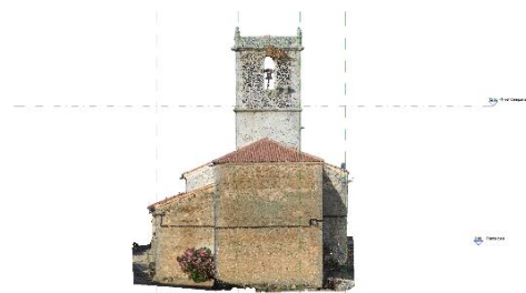
Imagen 100. Alineación de la nube de puntos, fachada este, Revit. Fuente: Elaboración propia
