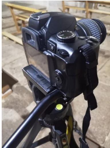
Imagen 62. Nikon D3000 acoplada a trípode con nivel de burbuja. Fuente: Elaboración propia
