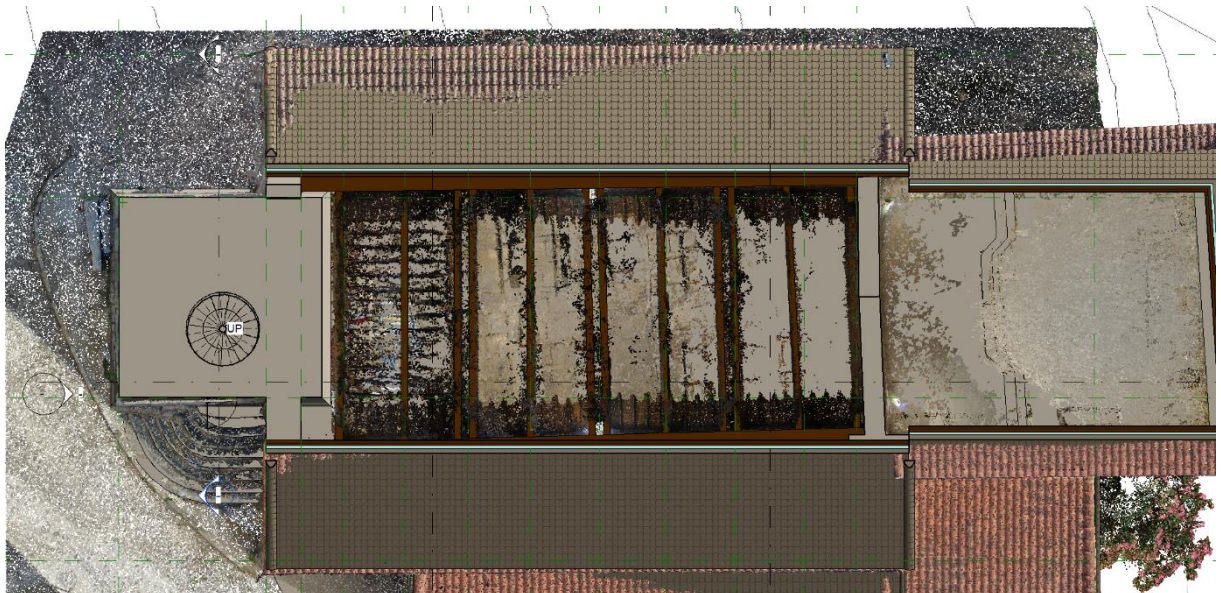
Imagen 112. Alineación de estructura de madera a la nube de puntos, Revit. Fuente: Elaboración propia
