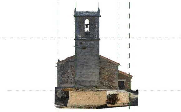
Imagen 101. Alineación de la nube de puntos, fachada oeste, Revit. Fuente: Elaboración propia
