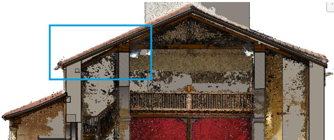
Imagen 119. Diferencia de inclinación entre la estructura de madera y la cubierta. Fuente: Elaboración propia
