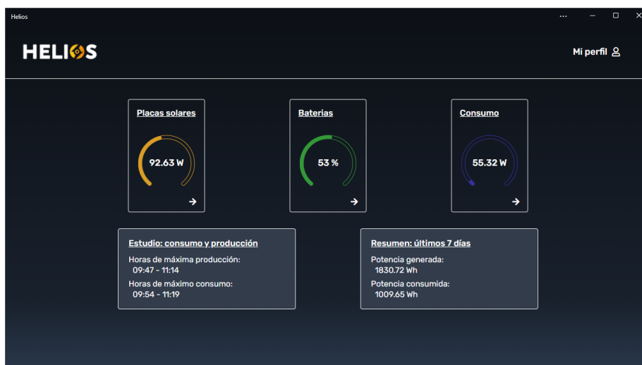
Ilustración 72: Pantalla principal monitorización
