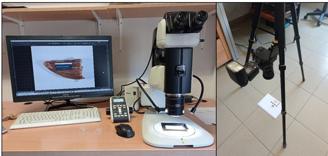
Figura 12 – Fotografías de equipos utilizados y el lugar de trabajo. A la izquierda microscopio estereoscópico Nikon SMZ18 con cámara Nikon DS-fi3, software NIS-Elements. A la derecha estudio fotográfico montado para fotografiar piezas de mayor tamaño, cámara Nikon D5500.
