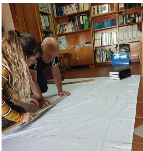
Figura 2: Proceso de confección de la pantalla tangente para el estudio mediante el dibujo de círculos concéntricos separados 10 centímetros entre sí.
