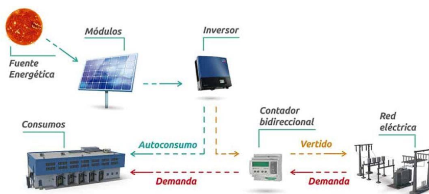
Ilustración 31. Instalación de autoconsumo con excedentes
