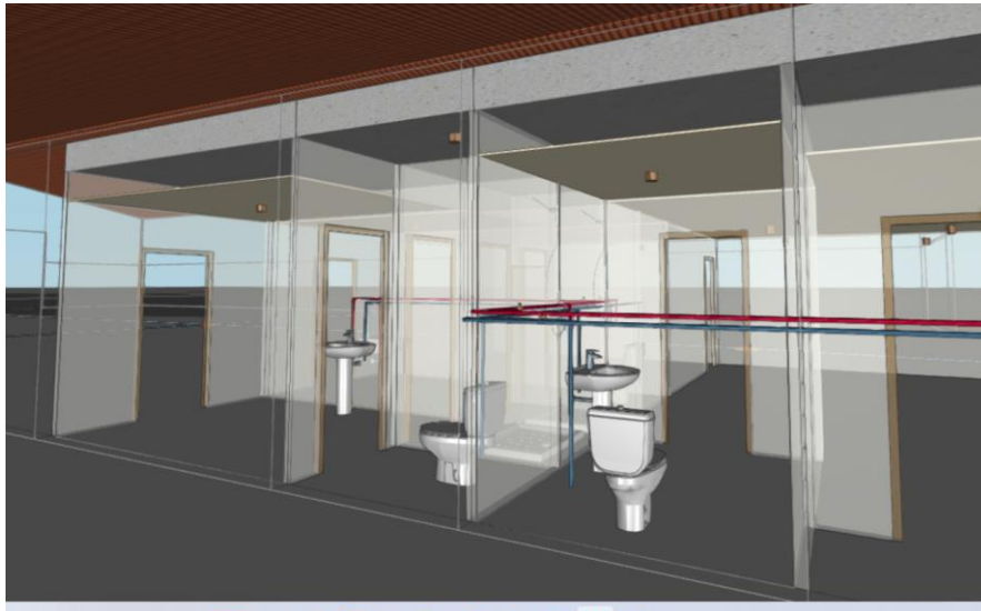
Ilustración 16. Instalación de ACS y agua fría
