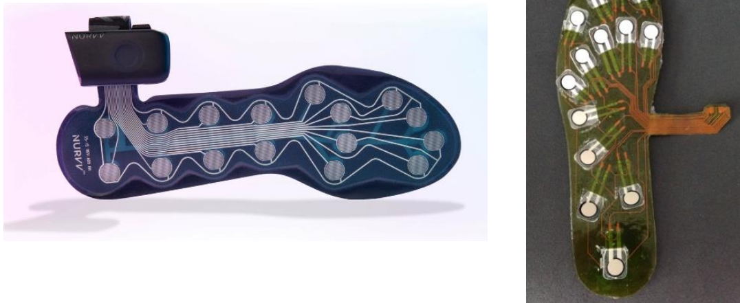
Figura 18.- Dos modelos de plantilla con los sensores de presión 15,16 .
