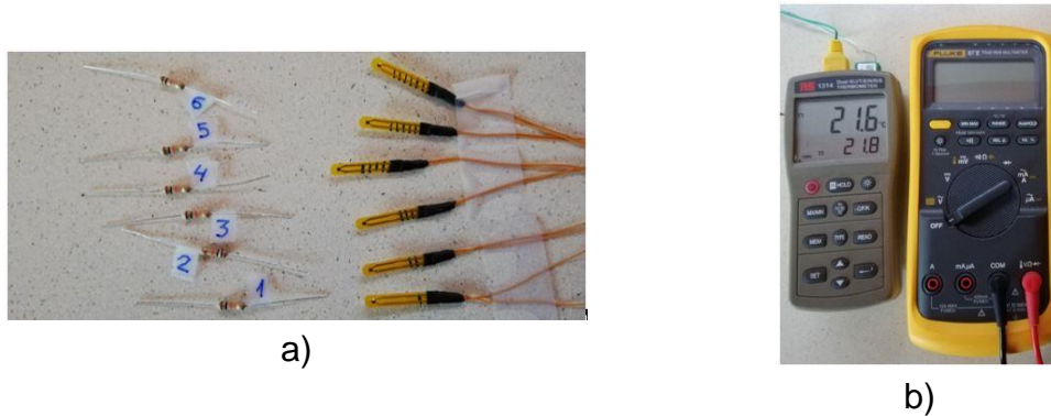
Figura 98.- a) resistencias y termistor NTC y b) dispositivos calibradas para tomar la temperatura y medir la resistencia 43 .
