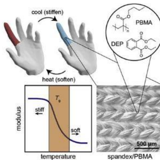
Figura 31.- Imágenes esquemáticas del comportamiento de un guante con tecnología textil térmica [49].
