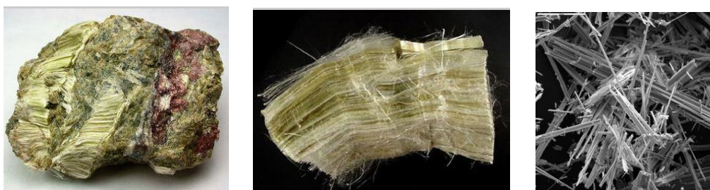
Figura 42.- Piedra de amianto, hilos obtenidos del amianto y vista al microscopio de las fibras minerales de amianto 31,32 .
