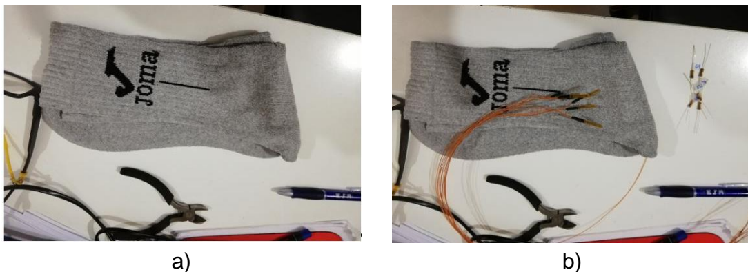
Figura 101.- a) calcetín deportivo y b) el mismo calcetín con los sensores a instalar y sus respectivas resistencias 46 .
