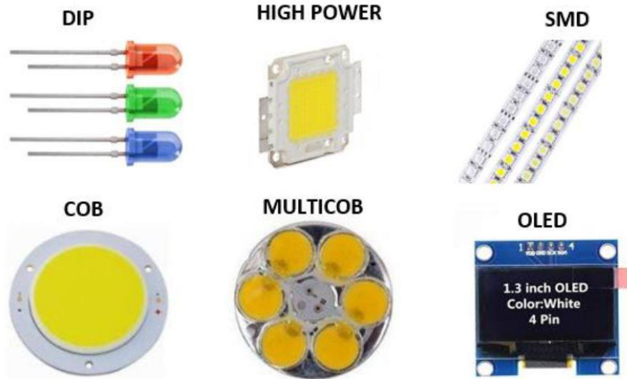
Figura 28.- Diferentes tipos de actuadores luminosos LED 25 .
