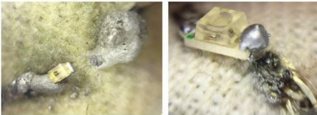
Figura 69.- Ejemplo de soldadura manual [84].
