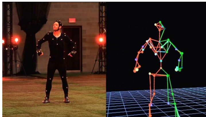
Figura 20.- Actor equipado con un traje de captura de movimiento óptico (por infrarrojos) y el esqueleto digital generado 18 .
