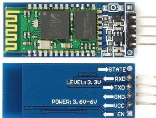
Figura 104.- Módulo bluetooth HC-06 con sus conexiones eléctricas 49 .
