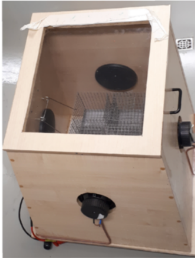
Figura 2. Caja de estimulación acústica donde se generó el trauma acústico (TA). Se trata de una caja de madera con cuatro paredes laterales dispuestas de manera no paralela para evitar efectos reverberantes. En cada una de estas paredes hay incrustado un altavoz, situados a diferentes alturas para que el ruido abarque toda la caja a la misma intensidad. En el centro de la caja se situaron 4 jaulas colgantes donde se introdujeron los animales que recibieron el TA.
