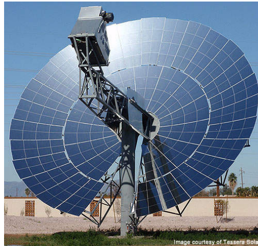
FIGURA A.23: Disco parabólico con motor Stirling, proyecto Maricopa, Arizona [Stirling Energy Systems, 2009].
