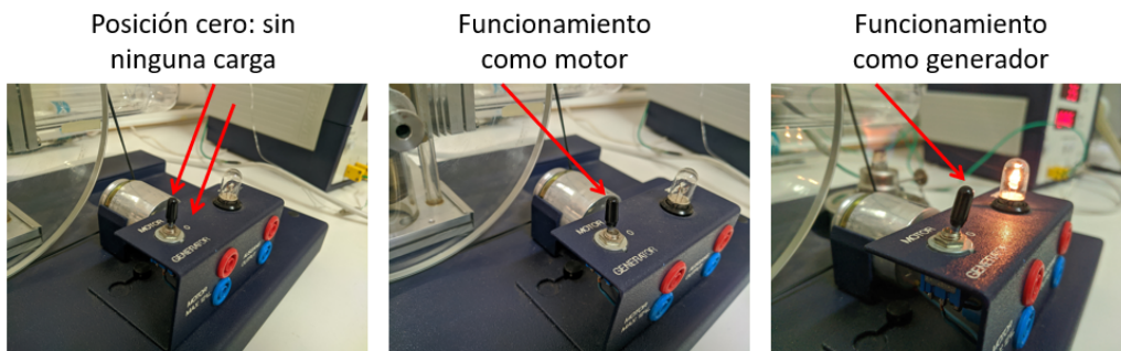
FIGURA 2.8: Distintas formas de funcionamiento del módulo del equipo del motor Stirling de combustión: la figura de la izquierda representa la posición cero (sin ninguna carga), la figura central representa funcionamiento modo motor y la figura de la derecha, el funcionamiento modo generador (lámpara incandescente encendida).
