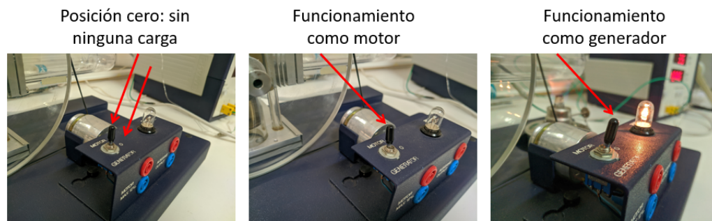
FIGURA A.3: Distintas formas de funcionamiento del módulo del equipo del motor Stirling de combustión: la figura de la izquierda representa la posición cero (sin ninguna carga), la figura central representa funcionamiento modo motor y la figura de la derecha, el funcionamiento modo generador (lámpara incandescente encendida).
