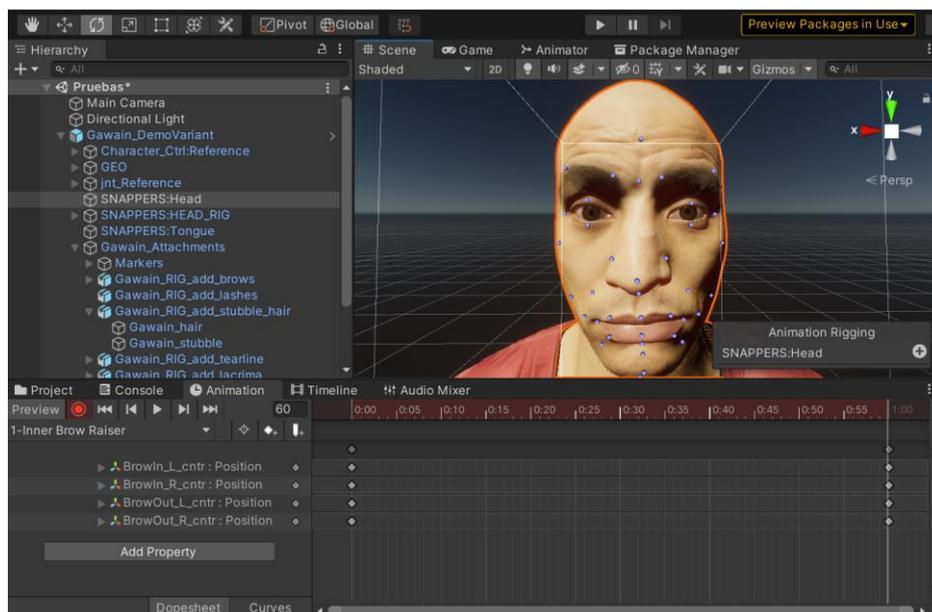
*Ilustración 17: Grabación de un Animation Clip haciendo uso de las transiciones generada automáticamente*
