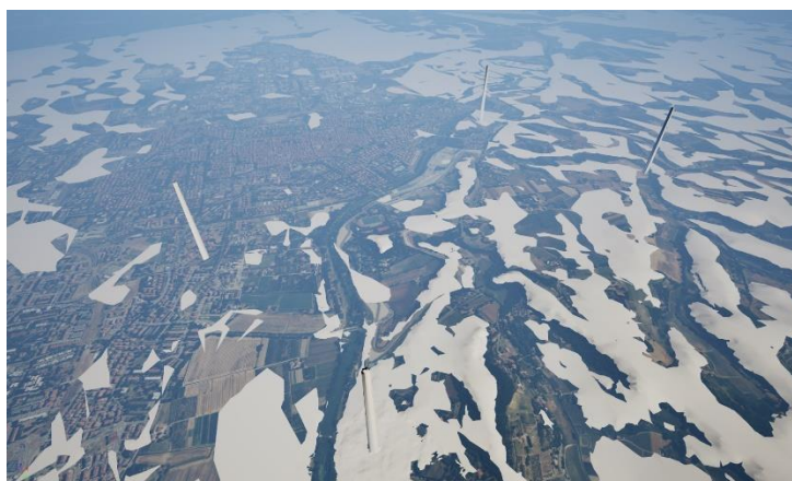
Ilustración 25. Diferencia entre datos de 30m y 5m. En blanco, las mejoras del de 5m
