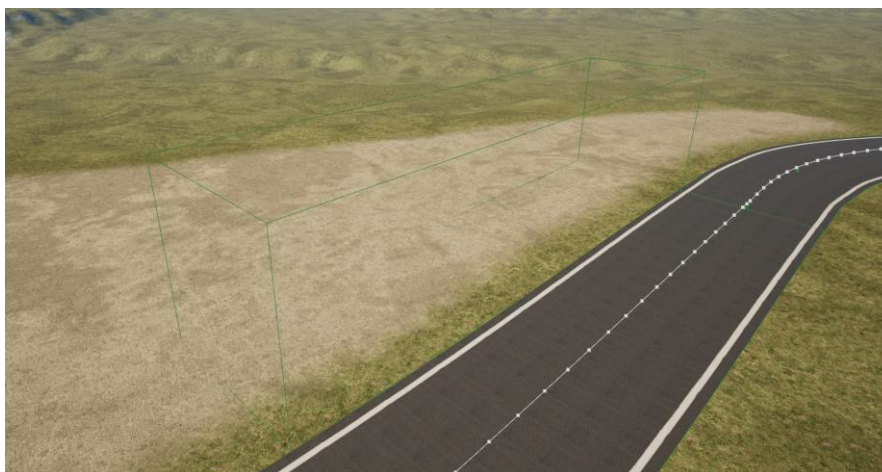
Ilustración 61. Zonas de detección de límites de pista
