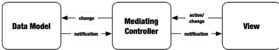
Ilustración 24: Patrón de diseño MVC mediado [22]
