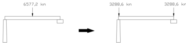
Fig. 35 Cargas puntuales en Pila 3 y Estribo 2
