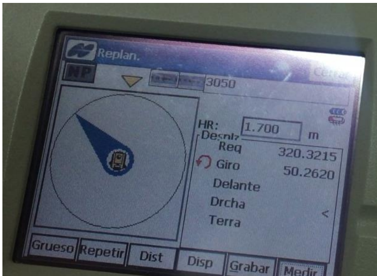
Ilustración 6: Programa de replanteo de la estación 4
