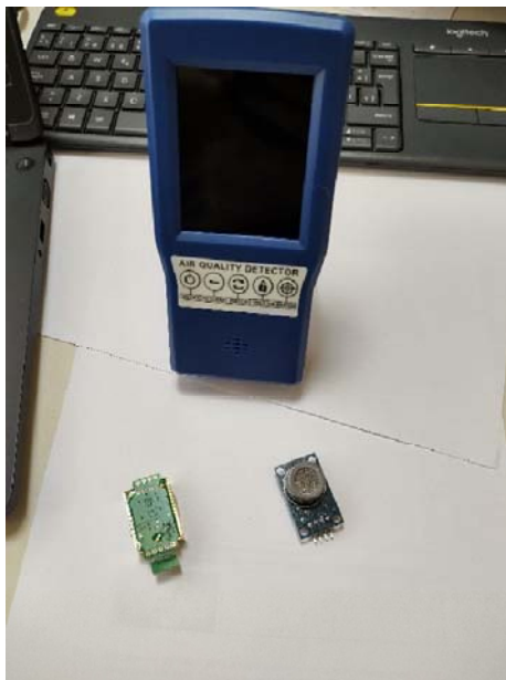
Figura 4a. Sensores usados y detector comercial usado como referencia para medidas de dióxido de carbono.
