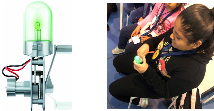
Figura 5.12: “Dynamo Torch” es una dinamo, de modo que al girar la manivela se enciende el LED verde del juguete (“Dynamo Torch de Green Science.” s.f.).
