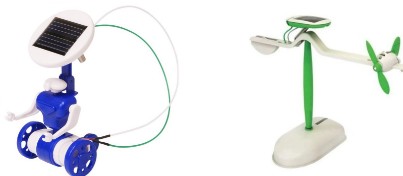
Figura 5.10: Juguetes solares equipados con placas fotovoltaicas, de modo que al incidir directamente el sol se ponen en movimiento. A la izquierda, “robot” solar de juguete (“Kit solar 6 in 1 de Edu Toys.” 2021). A la derecha, “avión” solar de juguete (“Kit solar 6 in 1 de Science4you.” 2021).
