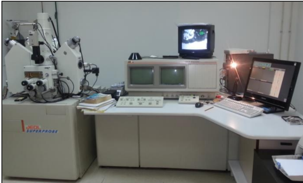
Fig. 12. Equipo de microsonda electrónica. Fuente: Elaboración propia.
