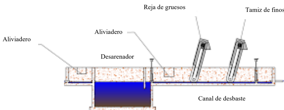
Figura 4. Esquema de un sistema de pretratamiento y desbaste
