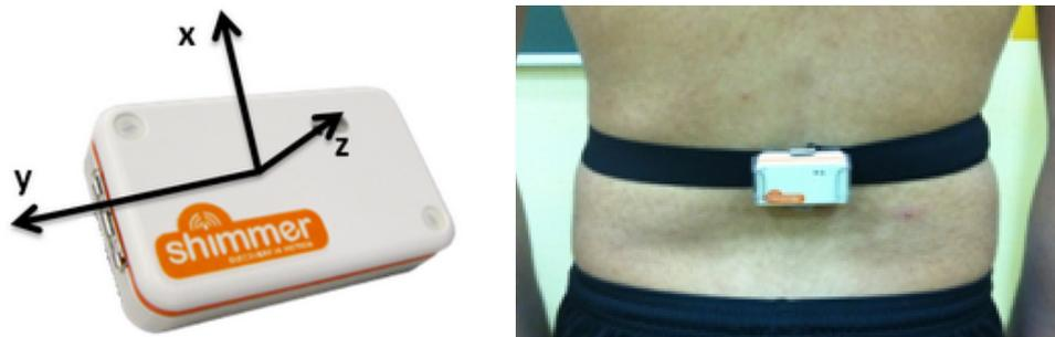
Figura 10. Disposición de los acelerómetros
