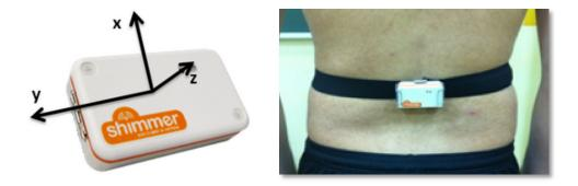
Figura 10. Disposición de los acelerómetros
