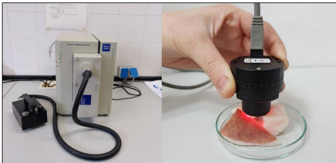
Figura 20: Equipos NIRS. Imagen de la derecha equipo Foss NIRS System 5000 e imagen de la izquierda equipo MicroNIR™ 1700.
