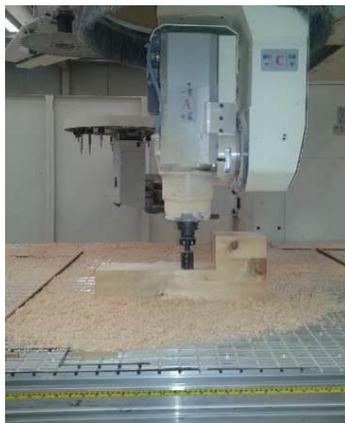
Fig. 4: Fresado por control numérico
