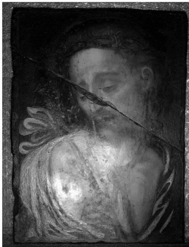
Fig. 9. *Ecce Homo*. La reflectografía IR permite ver el dibujo previo sobre la imprimación de la pizarra y sobre todo la obra original sin el repinte puntual que tiene en el torso (Reflectografía IR de Alejandra del Barrio Luna).
