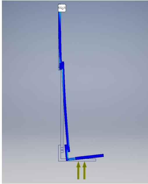
**Fig. 62.** Desplazamiento lateral de la estructura para el prototipo.
