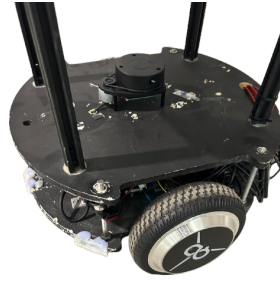
Figura 5: Prototipo de robot móvil con placa de Hoverboard (LIDAR A1)
