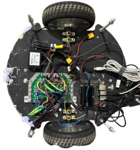
Figura 4: Prototipo de robot móvil con placa de Hoverboard
