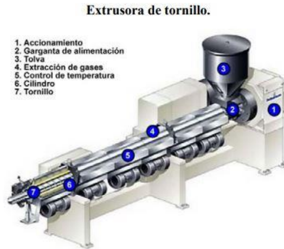
Figura 11. Componentes de un extrusor de tornillo. (Moscicki, 2011)
