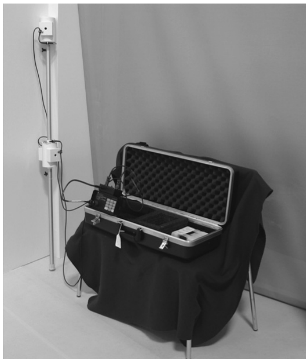
Figura 4.1. Magnetómetro de protones Geometrics G-856AX
