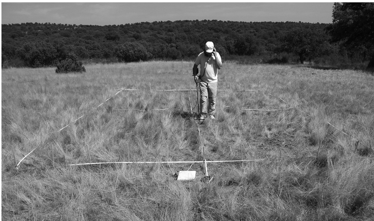
Figura 4.6. Toma de datos en el sondeo magnetométrico 201304
