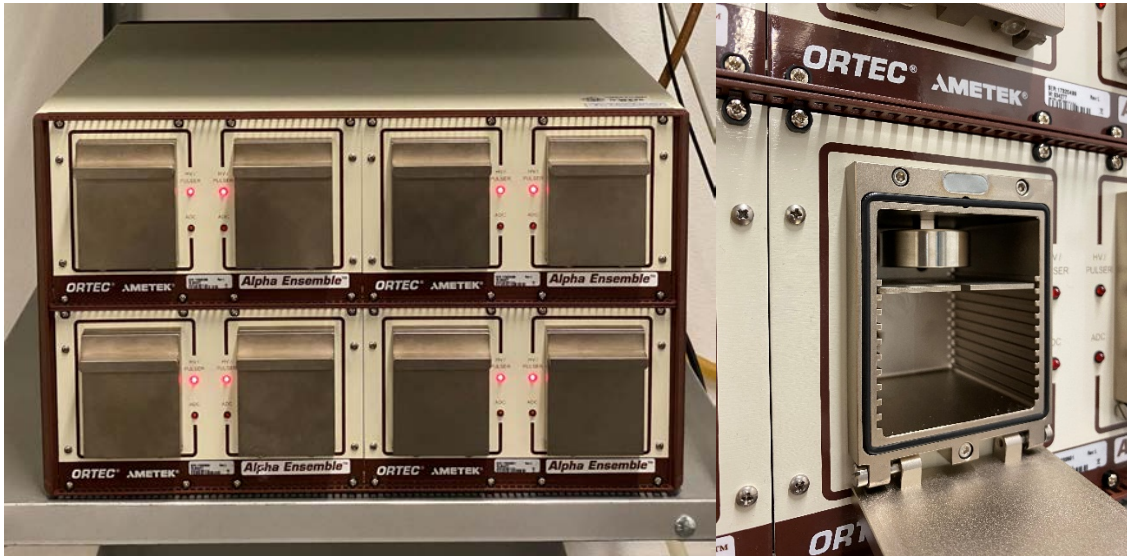
Figura 3.7. Sistema de espectrómetros \alpha utilizado para la medida de las fuentes preparadas para la determinación de los isótopos de uranio.
