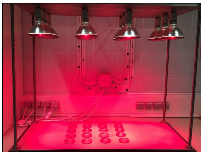
Figura 3.4. Evaporación de las fuentes bajo red de lámparas de luz infrarroja para la medida de los índices de actividad alfa total y beta total.
