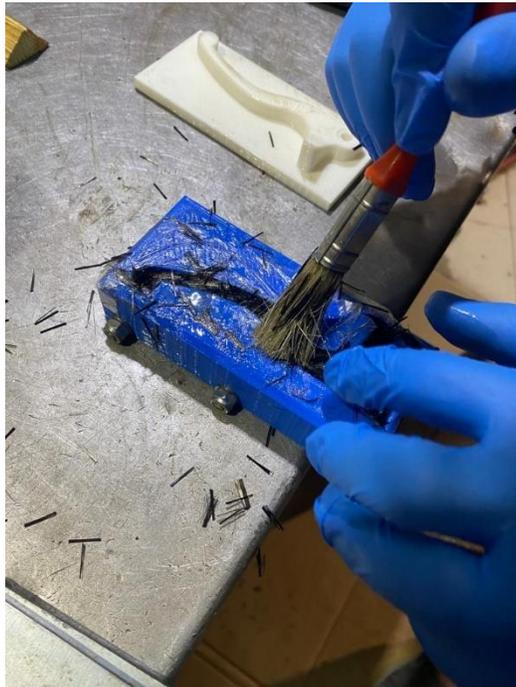
Figura 31. Colocación de la fibra y la resina en el molde
