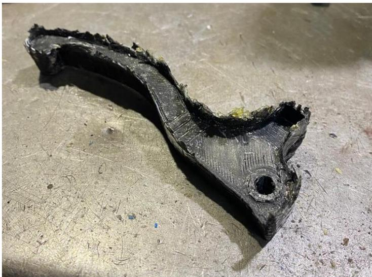
Figura 34. *Maneta extraída del molde sin operaciones de acabado*
