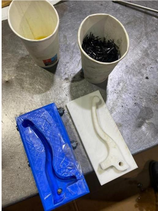
Figura 30. Preparación de los moldes, la fibra y la resina
