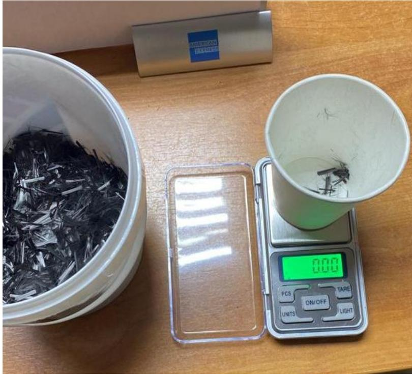
**Figura 18.** *Puesta a cero del recipiente en balanza*
