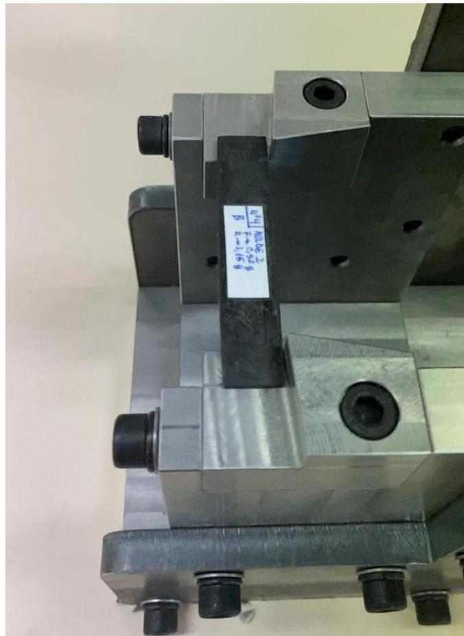
**Figura 40.** *Colocación de la probeta en el péndulo de Charpy*
