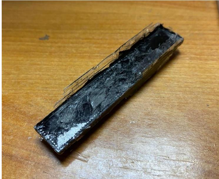
**Figura 25.** *Probeta recién sacada del molde*
