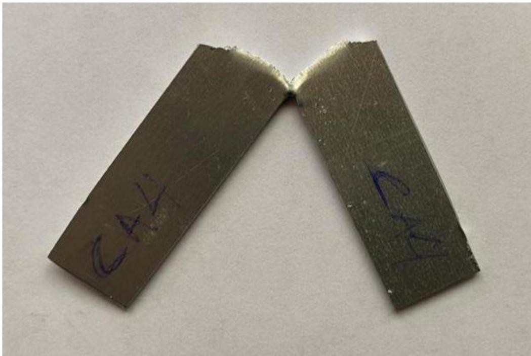
**Figura 41.** *Probeta después de ensayo de Charpy*
