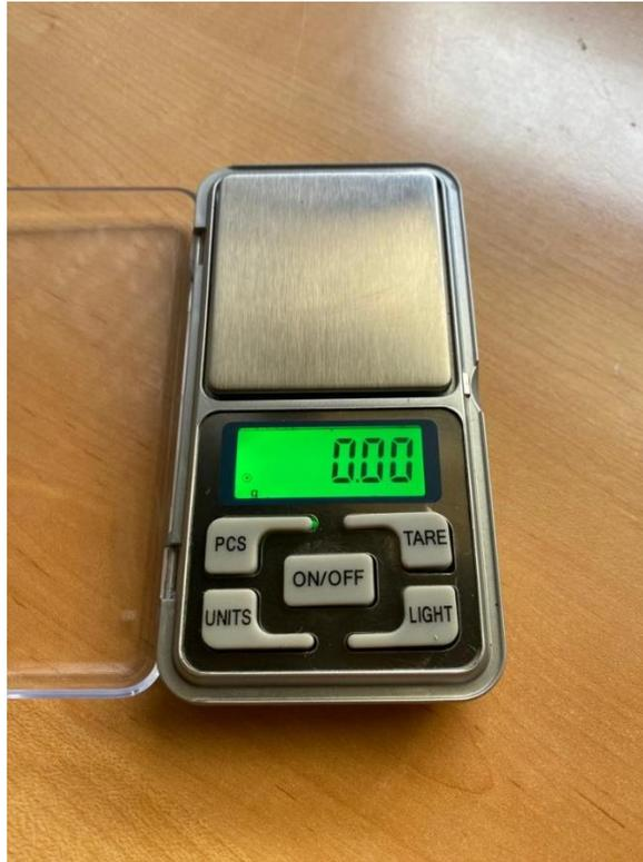
Figura 17. Balanza de precisión
