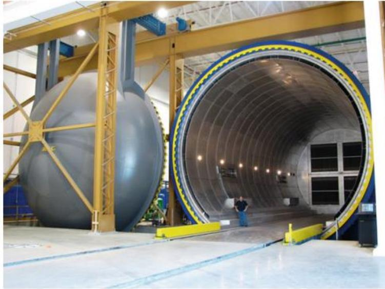
Figura 6. Autoclave utilizado en la industria aeronáutica
