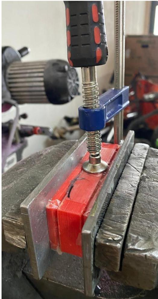
**Figura 23.** *Colocación del molde en el tornillo de banco*
