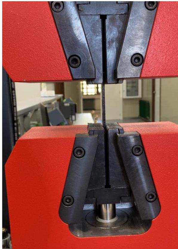
Figura 37. Colocación de la probeta en la máquina de tracción
