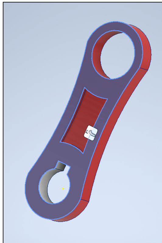
Fig 14.4: Restricción fija para las Barras. Realización propia.
