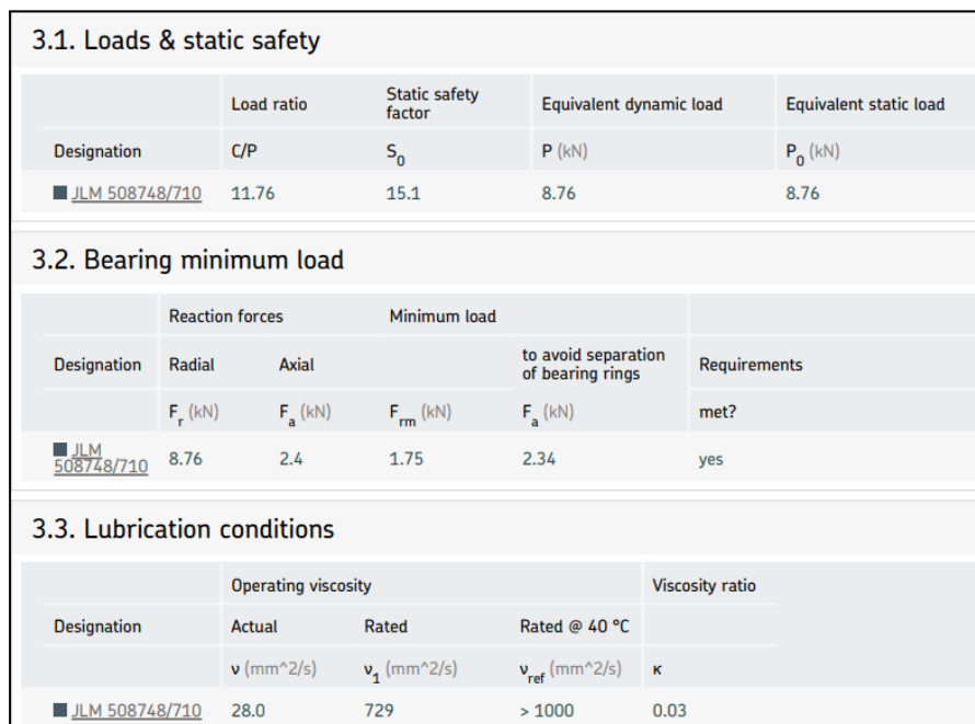
Fig 17.38: Resultados de la selección de rodamiento axial para las condiciones del pasador 2. Realización propia.
