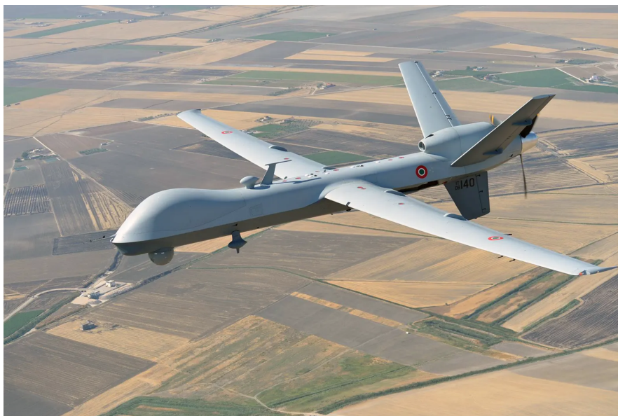
FIGURA 2.2: UAV de ala fija (MQ-9) con motor turbohélice
